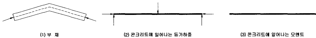
그림 5 연속강선에 의한 등가하중과 모멘트
