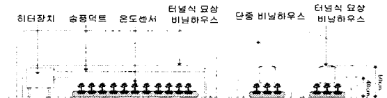
그림 1. 묘상 난방 시스템의 구조
