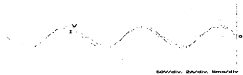
그림 7. 입력전압과 입력전류의 파형 Fig. 7. Waveform of input voltage and current
