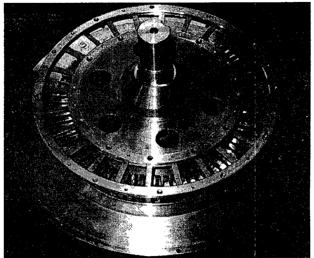
그림 2. 영구자석 풍력발전기의 회전자 사진 Fig. 2. A picture of rotor for an permanent-magnet wind-generator
