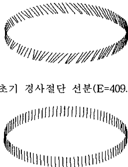
그림 6. 구의 레이어에 대한 경사절단 최적화 결과
