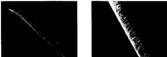
전압 : 1.8kV/cm 전압 : 2.7kV/cm Fig.7 전압에 따른 유리섬유의 식모상태
