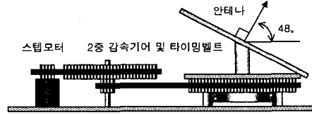
그림 4. Az 마운트의 구조 Fig. 4 Structure of Az mount
