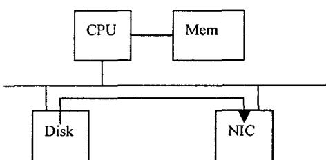
여기서 host CPU 는 처음에 데이터 전송을 초기화 시켜 주는 역할만 행한다. 이후 데이터는 host CPU 와 local bus 의 관여 없이 motherboard 의 DMA engine 에 의해 disk 에서 NIC 으로 전송된다. 또한 PCI bus 의 사용량도 앞의 operation 과 비교해서 반으로 줄어든다. 이런 direct path 를 실제 시스템에서 적용하기 위해 ‘sendfile’ system call 을 고친다. ‘sendfile’ call 은 디스크에서 읽힌 데이터가 결국 NIC 으로 가게 되는 것을 의미한다. 따라서 이 system call 을 사용하
