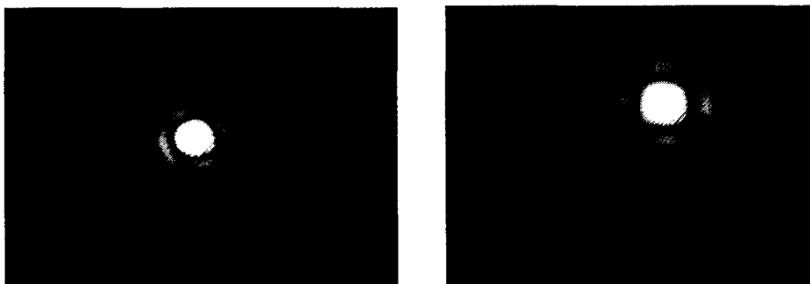
그림 2. Aperture가 없는 시편과 Si-probe Aperture가 있는 시편에서의 점광스폿의 고배율 현미경 측정사진
