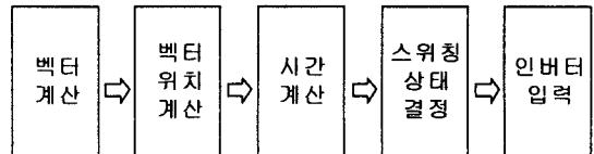
그림 3. 인버터의 스위치 상태 결정 과정
