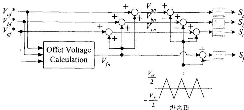
그림 3 제안된 옵셋전압을 이용한 4레그 VSI의 PWM방법
