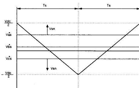
Fig. 5 옵셋 전압( $V_{sn}$ )
