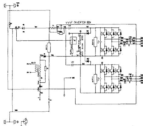
Fig. 1 자기부상열차 구동시스템의 주 회로도
