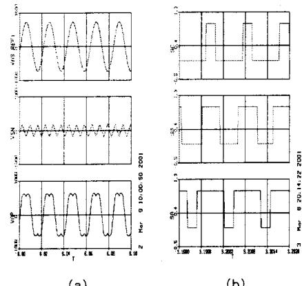
Fig. 6 공간벡터 PWM방식의 풀전압과 PWM 파형
