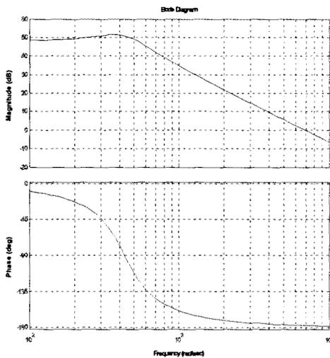
그림 9. 상태 평균화 방법을 이용한 이상적인 Boost Converter의 Bode Plot
