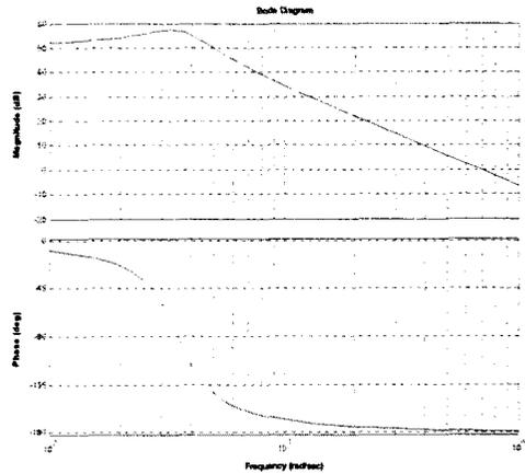
그림 16. PWM 스위치를 이용한 Boost Converter Bode Plot
