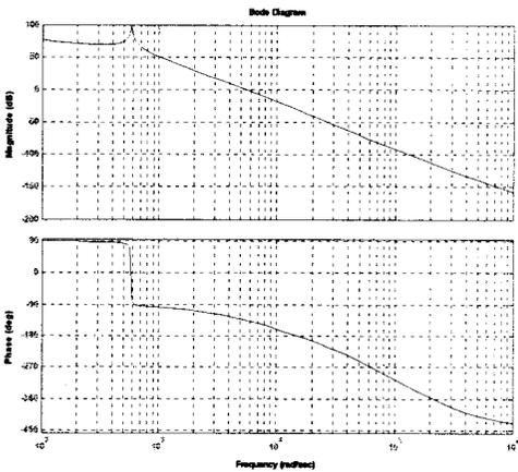
그림 23. 상태 평균화 방정식을 이용한 기생저항을 포함한 Boost Converter Phase를 보상을 한 Bode Plot
