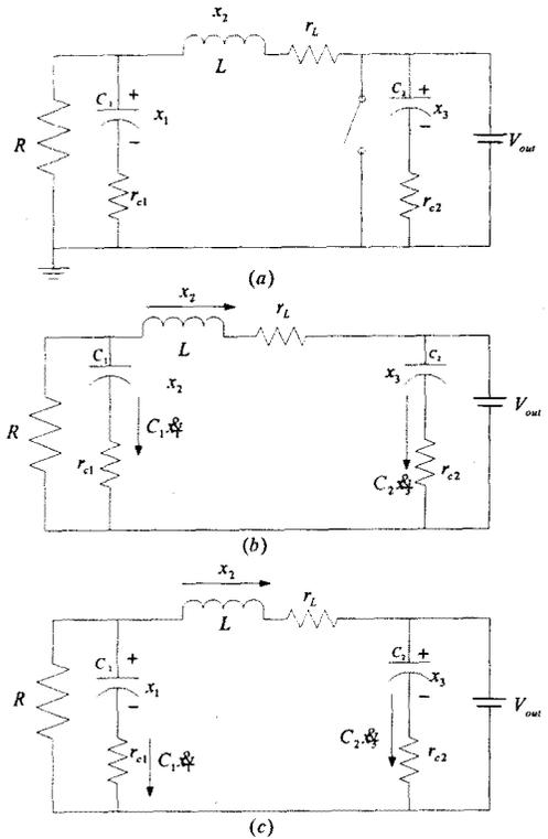
그림 10. 기생저항을 삽입한 Boost Converter
