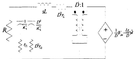
그림 17. PWM 스위치를 이용한 기생저항을 포함한 Boost Converter
