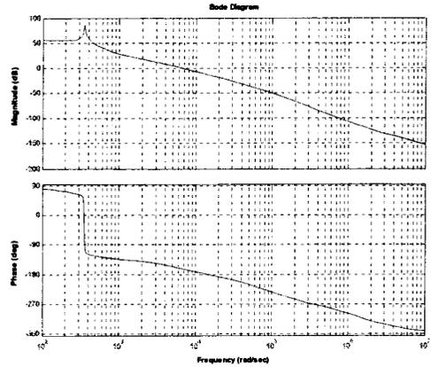
그림 24. PWM 기생저항을 포함한 Boost Converter의 Phase를 보상을 한 Bode Plot
