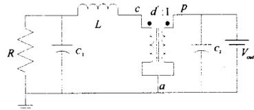
그림 12. PWM 스위치를 이용한 Boost Converter 회로도
