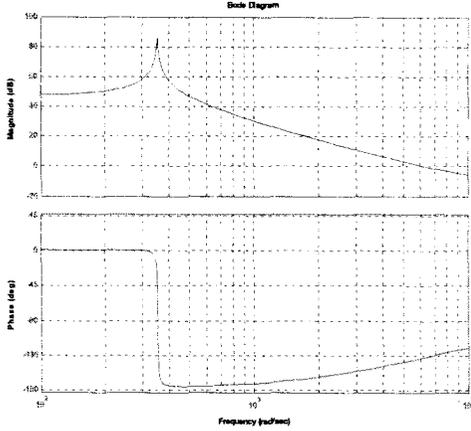
그림 18. PWM 스위치를 이용한 기생 저항을 포함한 Boost Converter Bode Plot
