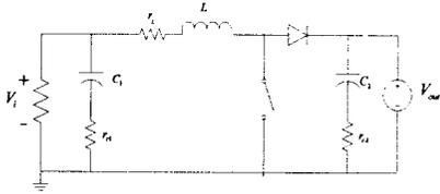
그림 3. 기생저항을 포함한 시스템 등가회로
