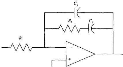
그림 19. Boost Converter에 들어갈 Type 2 제어기
