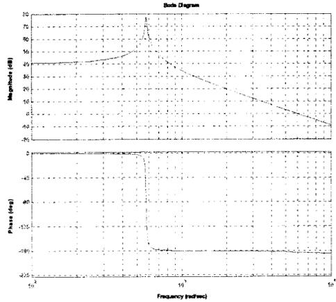
그림 11. 상태 평균화 방법을 이용한 기생저항을 고려한 Boost Converter Bode Plot
