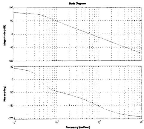
그림 21. 상태 평균화 방법을 이용한 이상적인 Boost Converter의 Phase를 보상한 Bode Plot
