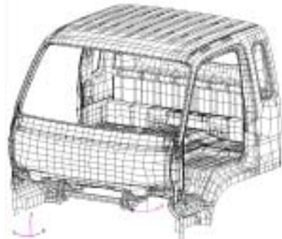
Fig. 5 Finite element model(MAC=0.44)
