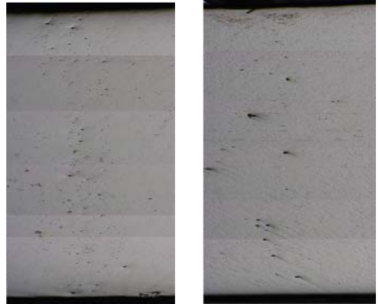
1차 제조 2차 제조 Fig. 8 모의제조 조직사진 (고입열)
