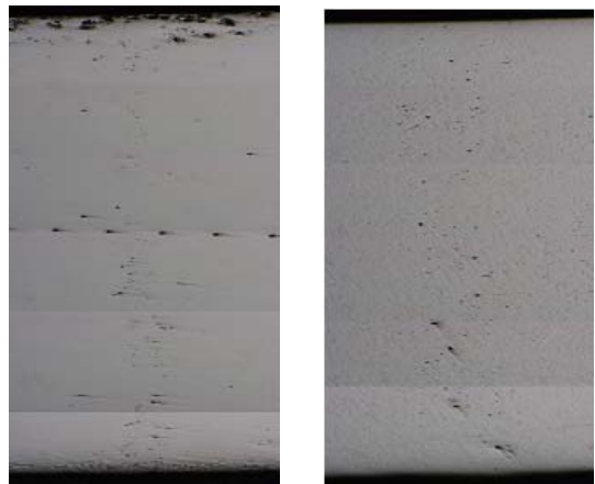
1차 제조 2차 제조 Fig. 9 모의제조 조직사진 (적정입열)
