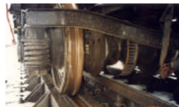
<그림 8> 폴란드 궤간가변 시스템
