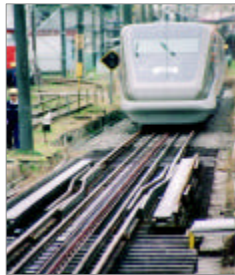
<그림 4> 일본 RTRI의 궤간가변 열차 및 지상설비
