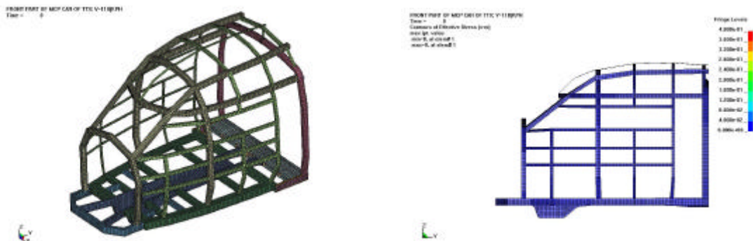
그림 1 TTX Mcp Car 전두부 골조의 충돌해석 모델
