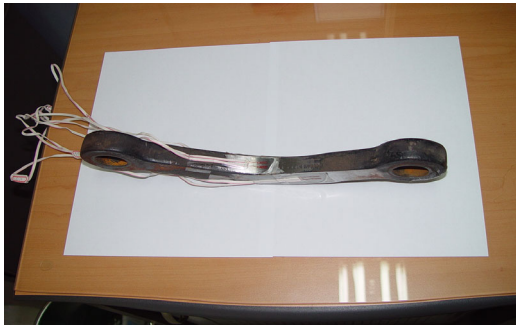
그림 1 압축하중 측정용 수직방향 게이지
