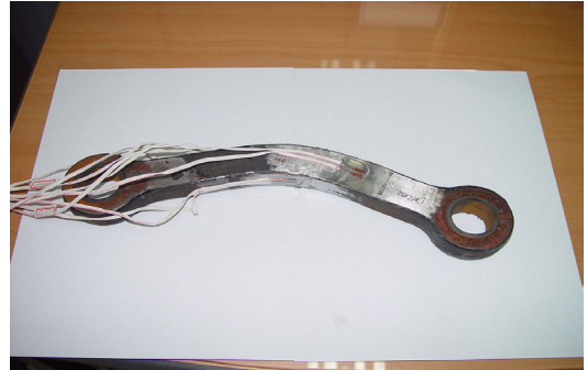
그림 2 굽힘하중 측정용 수평방향 게이지
