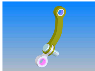
그림 10 비틀림 흡수구조형 Holder hanger
