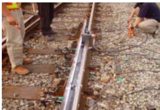
그림 3. 가드레일 검정기 재하 모습
