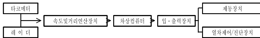
그림 2 차상신호시스템 제동제어 구성도
