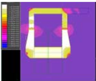
그림 3. 전자석 2차원 해석 모델
