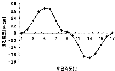
그림 2. BLDC 전동기의 영구자석 초기 모델의 코깅토크
