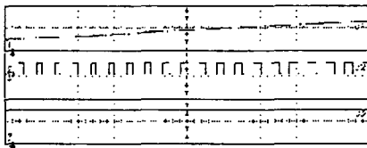
그림 6. 부하토크 증가 시 PLL에 의한 동적 도통각 변화: CH1) 부하토크 (0[kg?cm] → 90[kg?cm]), CH2) 도통각 CH3) 속도 1500[rpm] Fig.6. Dynamic dwell angle variation by PLL control when load increase: CH1) load torque (0[g/cm] → 90[kg/cm]) CH2) dwell angle CH3) speed 1500[rpm]
