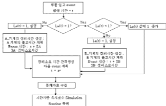
Fig.6 두 개의 라인을 가지는 유지보수 시스템 부품 입고 기반 알고리즘
