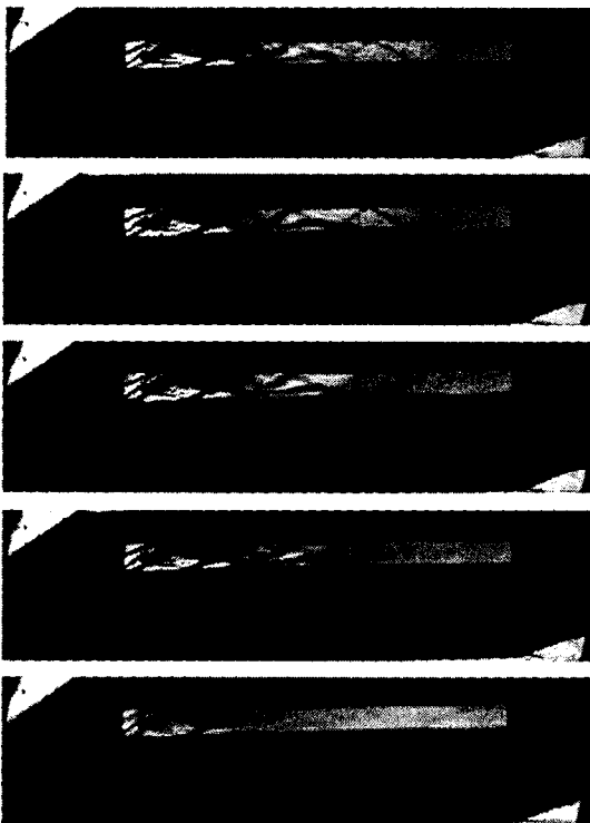
Fig. 3 면적비율에 따른 Schlieren 가시화 (위쪽부터 48%, 51.5%, 55%, 58.4%, 63.4%)
