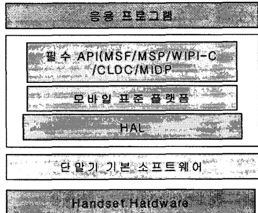
▶▶ 그림 1. 위피의 개념적 구조도
