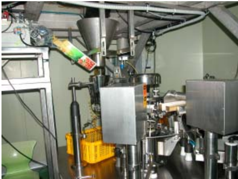
<그림 2> 자동중량측정에 의한 포장 공정
