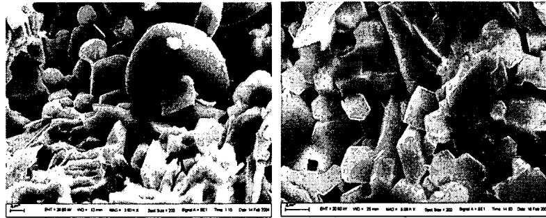
그림 3. 합성된 클링커의 SEM 사진
