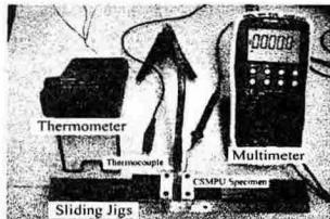
그림 2 전기적 특성 검출용 실험 장비
