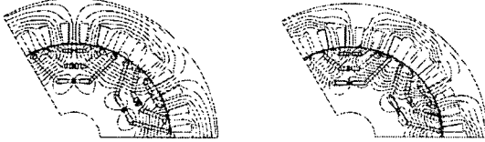
〈그림 4〉 부하 상태 시(id=120 [Apeak], iq=240 [Apeak]) 해석모델의 자체해석결과(유한요소법 적용). (a) 영구자석 단일여자(FPM 미적용). (b) 영구자석 단일여자(FPM 적용)
