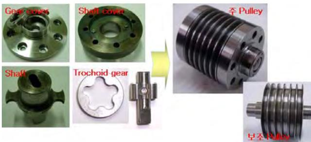
Fig.4 제작된 Pulley 구성요소
