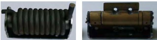
Fig. 5 Spring & damper hinge
