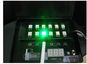
그림3 조명부에 사용될 최적 LED 선정을 위한 비교장치
