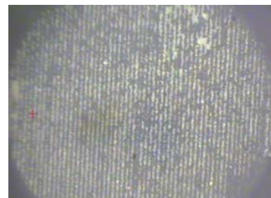
그림.2 미세격자 구조가 가공된 광섬유 단면 사진.
