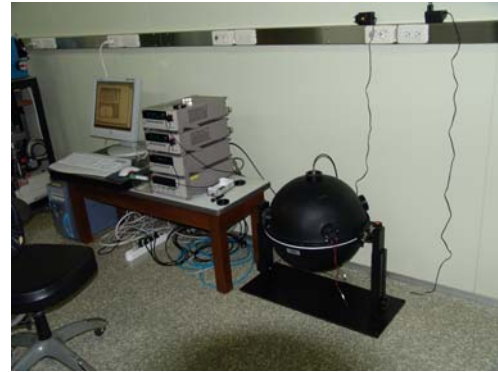
그림 4. 광검출기의 직선성 측정 장치
