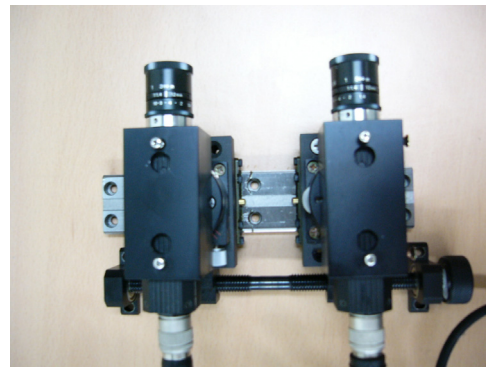
그림 1 CCD를 이용한 입체영상 획득 시스템
