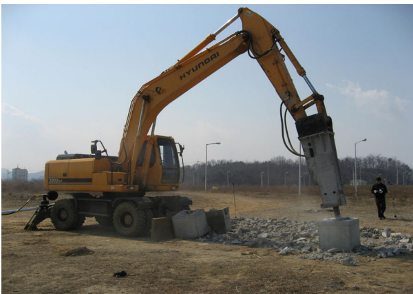
그림 1. 브레이커 소음 측정 시험 사진.
