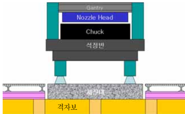
그림 2.2 정밀장비 및 현장구조물 설치단면 개념도
