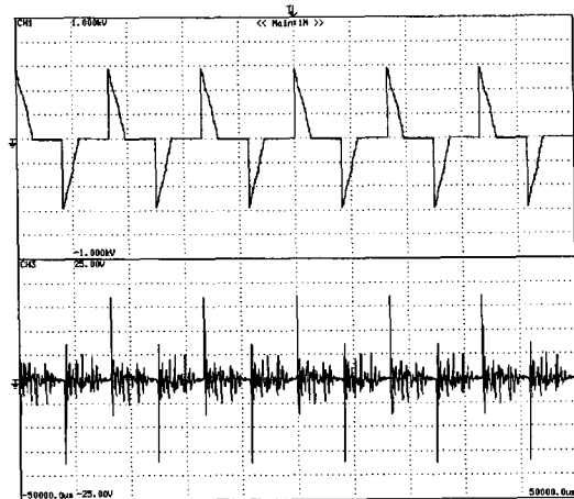
상 : 램프전압 [100V/div, 10ms] 하 : 필터 출력전압 [ 5V/div, 10ms] 그림 5. 조광시 램프전압 및 필터 출력전압
