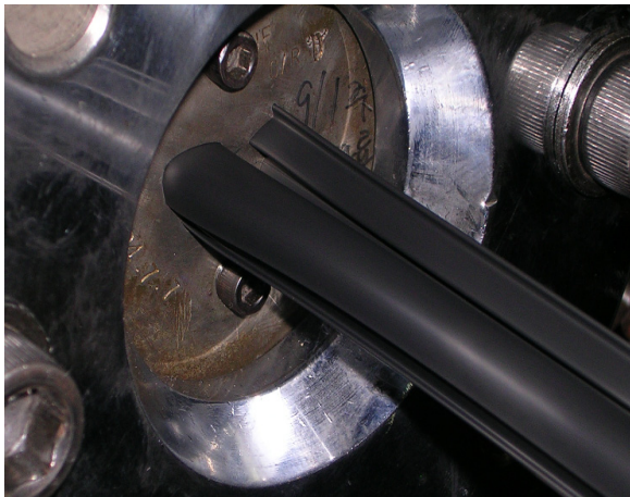
Fig. 7 Actual Extrusion Forming Process
