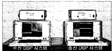
그림 3. 구현된 수중음향 데이터 통신 시스템
