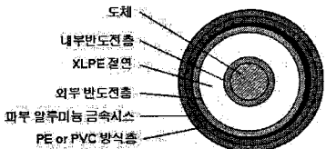
[그림2. AC XLPE cable 구조]
