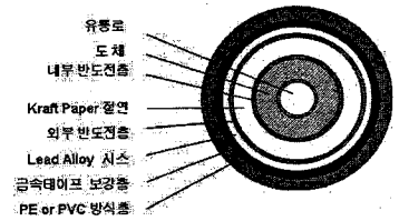
[그림1. AC OF cable 구조]
