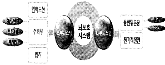
그림 3 뇌 보호시스템 Fig. 3. Lightning protection system
