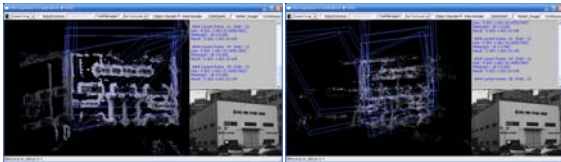
그림 7. 3차원 평행선을 이용한 자세 추정 결과 (건물 좌측 scene)
