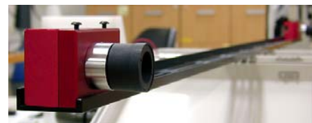
그림 4. Base line length 변경이 가능한 스테레오 카메라
