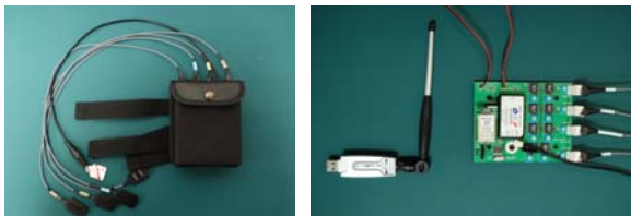
그림 3. (a) 무선 착용형 근전도 단말기외형 (b) 무선 단말기의 내부 및 무선통신 모듈
