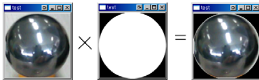
그림 4. 이미지(좌)에 RGB값이 배경은 (0,0,0)이고 가운데만 (1,1,1)인 이미지(중)를 곱한 결과(우)
