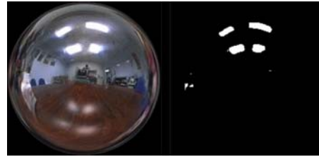
그림 6. 좌측은 찾아낸 미러볼 이미지 오른쪽은 미러볼이미지를 대비와 밝기를 조정하여 광원 부분(흰색)을 추정한것
