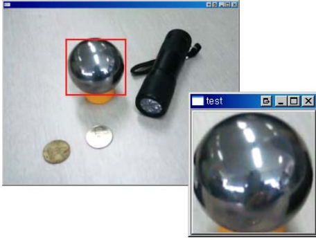
그림 3. 입력(좌측)에서 허프변환과 히스토그램 값을 고려하여 미러볼 이미지를 추적
