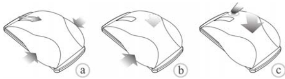
그림 5. (a) 스크롤 속도 조절, (b) 수평 스크롤, (c) 우클릭 후 압력으로 팝업 메뉴 선택
