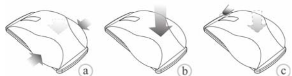
그림 4. (a) 마우스의 양 옆을 움켜쥐어 줌인, (b) 마우스의 윗면 눌러 줌아웃, (c) 줌 실행 시 마우스 프레임을 터치하여 손을 놓아도 현재의 줌 상태 유지
