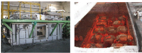
보바닥 가열로 시험체 배치 사진 1. 보바닥 가열로 외부 및 내부 시험체 전경
