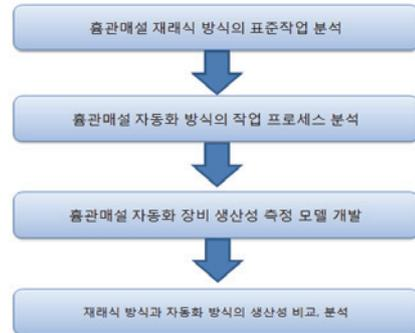
그림 2. 콘크리트 흙관매설 자동화 장비의 생산성 평가 프로세스
