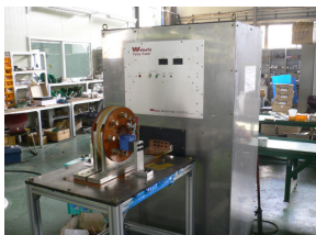
그림 1. 전자기 펄스 용접장치 및 사양
